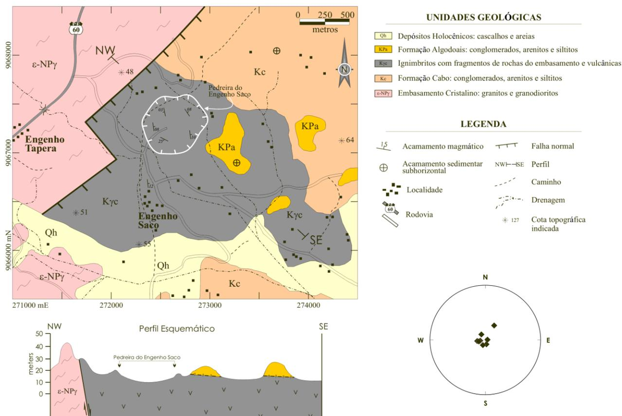
**Figura 3** – Mapa geológico e perfil esquemático da região de ocorrência dos ignimbritos (Nascimento, 2003). Na porção central do mapa ocorre a Pedreira do Engenho do Saco (ver figura 3a). A projeção estereográfica, usando o hemisfério inferior, mostra os pólos dos planos de acamamento nos ignimbritos, definido pela orientação dos *fiammes*.
