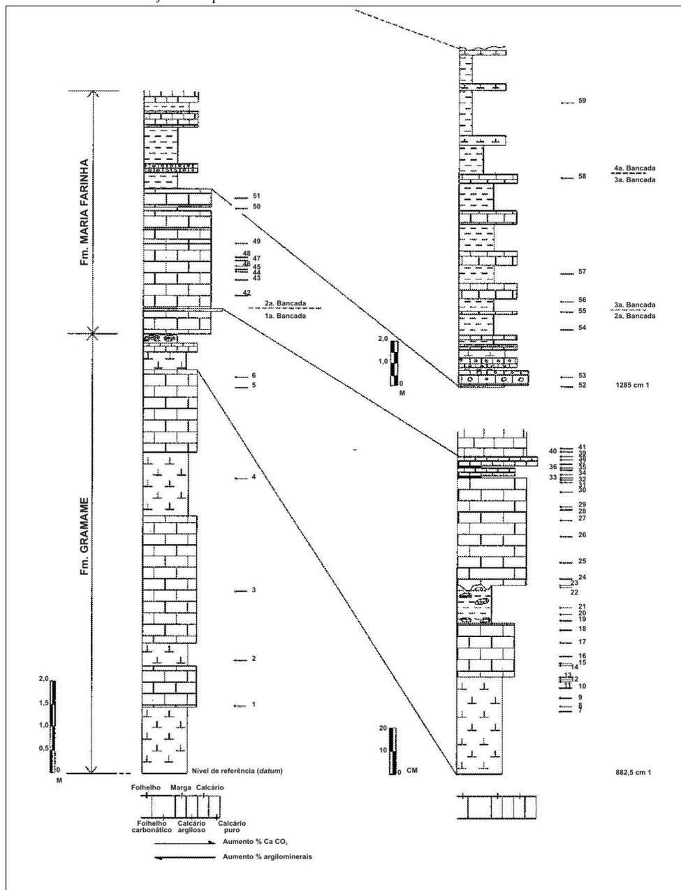
**Figura 4** – Seção geológica esquemática da pedra Poty. As posições estratigráfica das amostras 1-59 estão indicadas. Detalhes da seção (parte inferior, lado direito da figura) são também mostrados na Fig. 6. Os símbolos litológicos são os mesmos da Fig. 6. Ver outros detalhes no texto.
