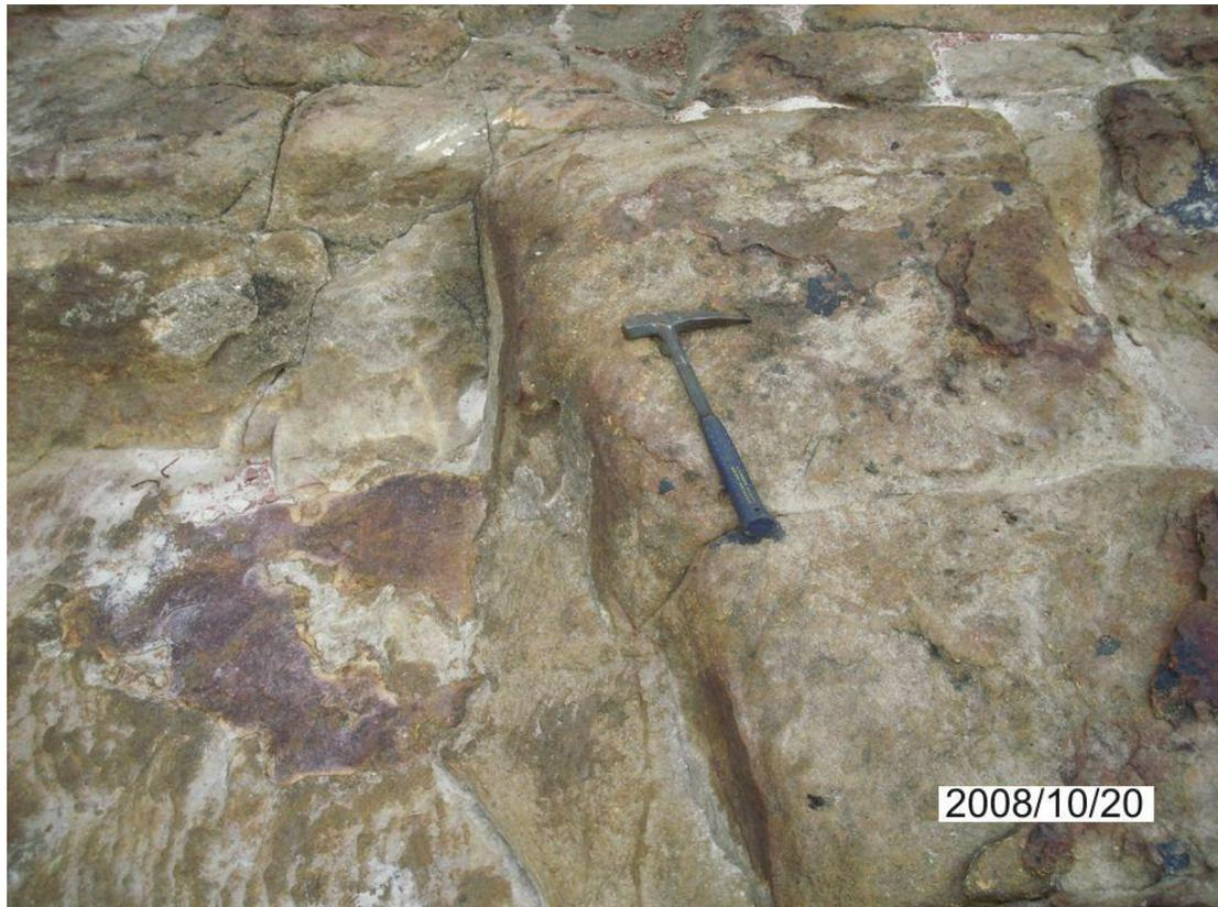
**Figura 16** – Juntas/falhas escalonadas que comprovam a tectônica direcional.
