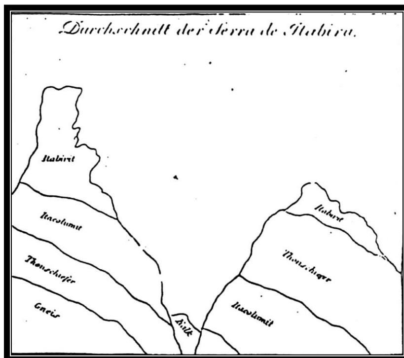
**Figura 2** - Perfil topográfico-geológico e esquemático através da Serra de Itabira (*Durschnitt der Serra de Itabira*) com a representação do Pico (retirado de Eschwege, 1822). Descrições litológicas: **Itabirit** (itabirito), **Itacolomit** (quartzito), **Tonschiefer** (xisto argiloso, filito), **Kalk** (calcário), **Gneis** (gnaisse).
