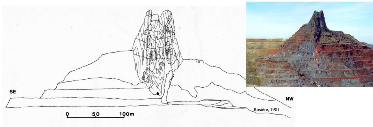
**Figura 5** - Reconstituição fotogramétrica do Pico de Itabira (Rosière, 1981) visto do Norte, com representação das principais estruturas planares (acamamento e diáclases). Ao lado, fotografia com visão aproximadamente do mesmo ângulo, datada de 2004 (MBR).
