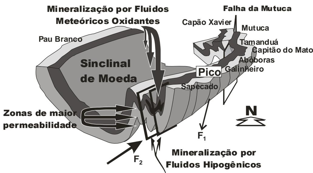
**Figura 6** - Bloco-diagrama esquemático do Sinclinal de Moeda, com representação das principais jazidas no flanco Leste e diferentes famílias de dobras. Na figura é representado o controle estrutural da mineralização em Ferro.
