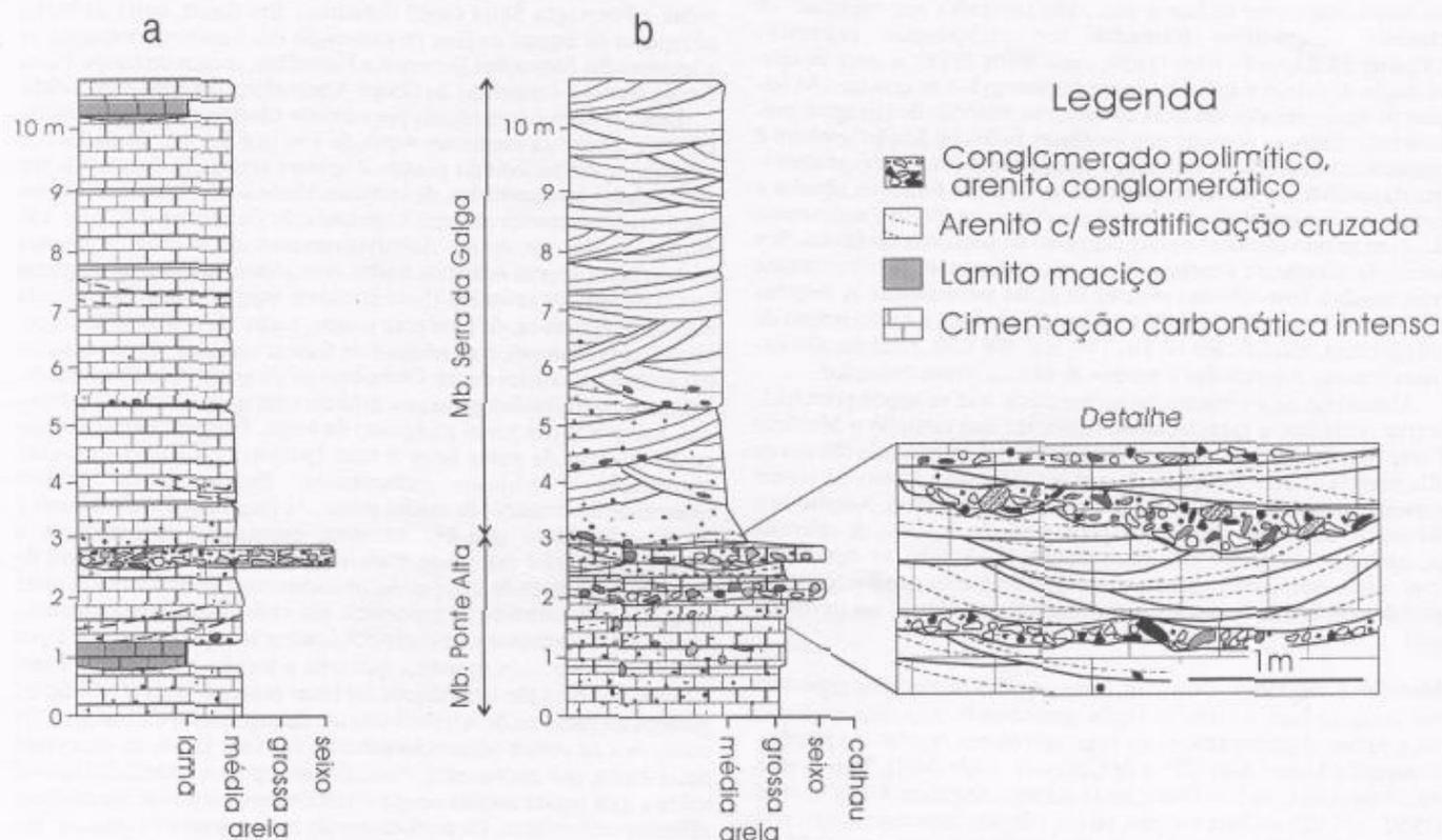
Figura 9 - a) Seção-tipo do Membro Ponte Alta, Pedreira do Lajeado, Serra do Veado, próxima de Peirópolis (Uberaba, MG); b) seção complementar: corte do km 153, rod. BR 050 (contato com o Membro Serra da Galga).
