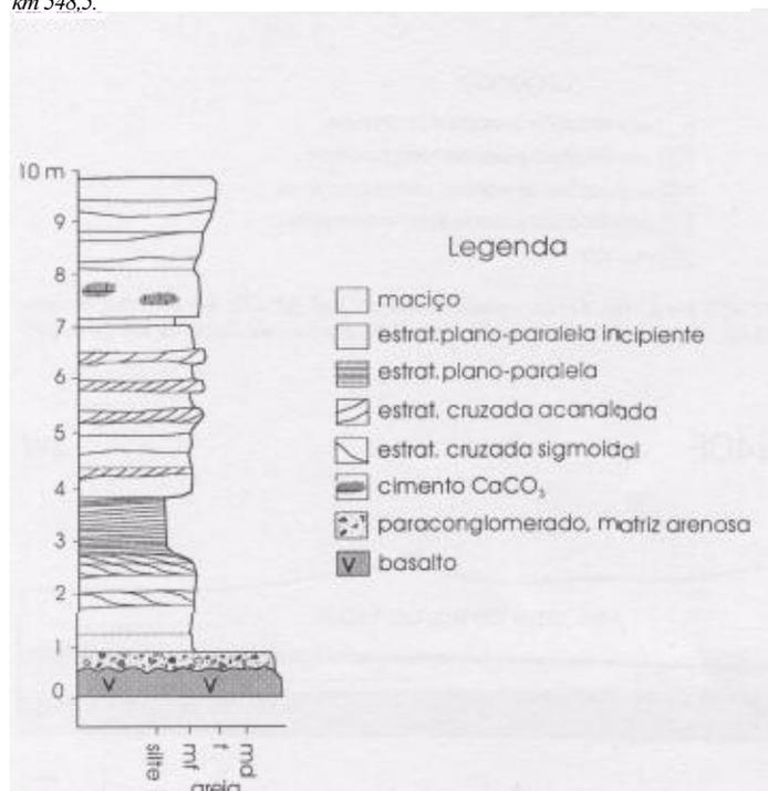
Figura 7 - Seção-tipo da Formação Uberaba. Local: ferrovia Fepasa, cruzamento com a rod. BR 050 (~km J 28).
