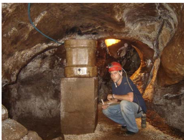
Figura 17 - Caixa d'água para armazenar os gotejamentos provenientes da rocha.
